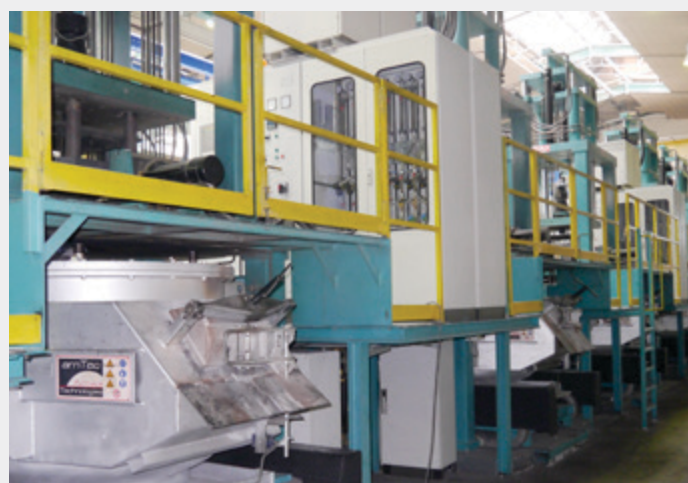
Bild 2: amTec-Niederdruckguss-ofen (Quelle: amTec Furnace Technologies GmbH)
