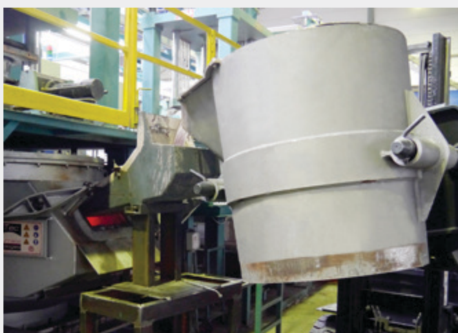
Bild 1: Überführen der Aluminiumlegierung in den Niederdruckguss-ofen (Quelle: amTec Furnace Technologies GmbH)
